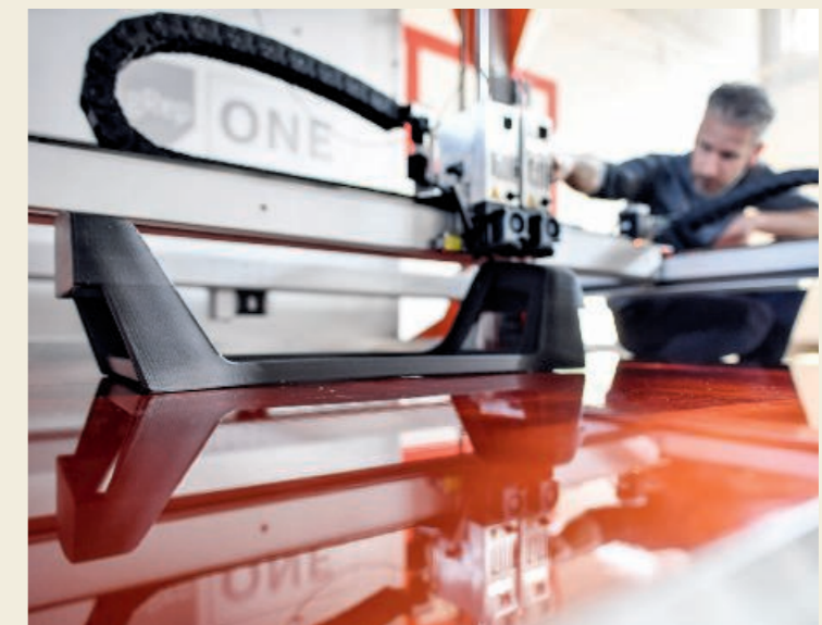
3D-Druck einer Kopfstütze beim Berliner Start-up BigRep
