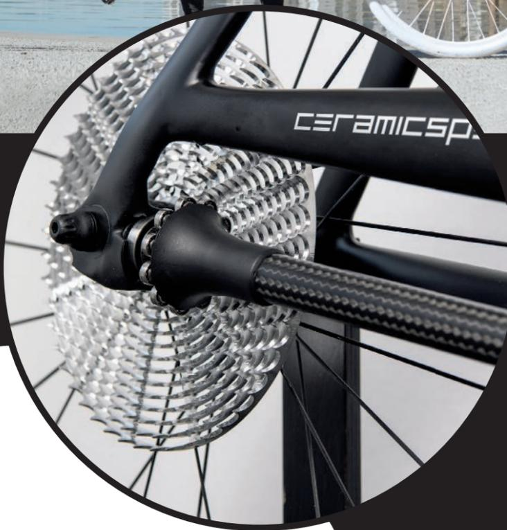
**NIE MEHR ÖLEN** Hätte, hätte, denkt sich mancher Radfahrer, wenn die Kette mal wieder schmirgelt. Ans Ölen muss man bei dieser Erfindung aus Dänemark nie wieder denken. „Ceramic Speed“ ist eine Art Kardanantrieb fürs Fahrrad, bei dem die Kraft über Keramik-Kugellager übertragen wird. Der Vorteil des Rennradgetriebes, das in Kürze auf den Markt kommen soll: 50 Prozent weniger Reibung als bei einer Kettenschaltung. [ceramicspeed.com](http://ceramicspeed.com)
